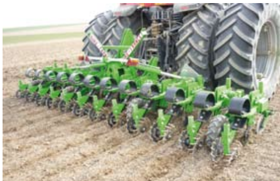
Application du Strip Till A après mulchage superficiel avec bêches roulantes (Compil) le 17 mars à DOSNON (10)
