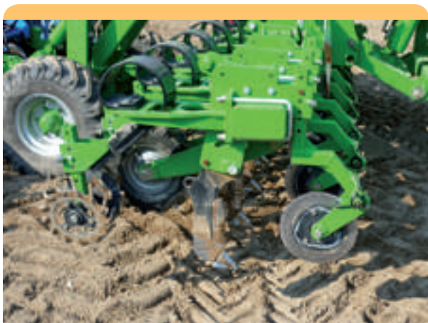
Figure 1 : Pièces travaillantes sur Strip Till Duro.
