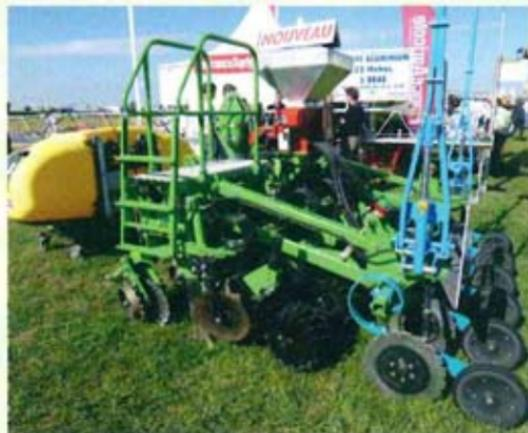
propose dorénavant une pointe de dent renforcée au carbure. Il adapte également sur demande un module de semis à disques fourni par Sulky et une trémie de 80 litres pour l'implantation du colza, voire de la féverole. Le doseur électrique, fourni par Sepeba, fonctionne en DPAE. Duro monte également une turbine, pour le transport pneumatique de
