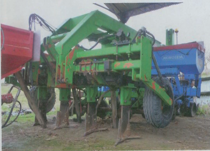
Les dents à ailettes portent des descentes de fertilisation localisant une fumure azotée entre 10 et 15 cm au-dessous du rang.
